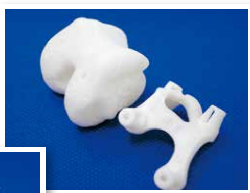
(写真上) 左側が大腿骨関節の模型。 右側がガイド装置
